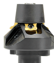
Fresa de radio de 45° con 3x2 aristas de corte y rodillo guía, equipada con plaquetas de radio de 3mm tipo R-K
