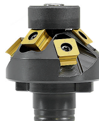
fig. Fresa de chaflán a 45° con aristas de corte 3x2 y rodillo guía, provista de 6 plaquetas indexables de chaflán del tipo K
